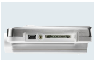
本体右側面のUSB-miniとSDカードの インタフェース
