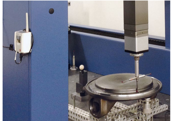
Klimaüberwachung im Messraum mit einem testo Saveris-Datenlogger.
